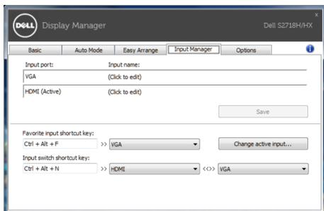
**OPOMBA:** DDM komunicira z vašim monitorjem, tudi če je na monitorju prikazana slika iz drugega računalnika. DDM lahko namestite v računalnik, ki ga pogosto uporabljate, in upravljate preklapljanje med vhodi v tem računalniku. DDM lahko namestite tudi v druge računalnike, ki so priključeni na monitor.
